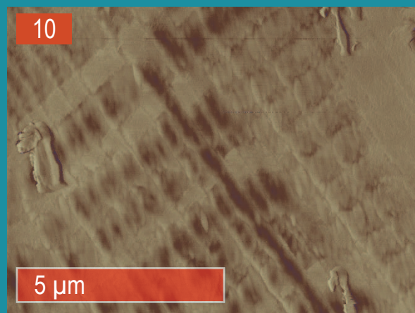
6. ACM изображение участка (2). Топография. 600х700 точек. 7,8. ACM изображения участков (7,8). Топография. 1000х1000 точек. 9,10 ACM изображение участка (5). Топография (9), изображение в фазовом контрасте (10). 1000х750 точек.
