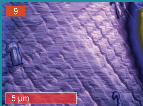
6. ACM изображение участка (2). Топография. 600х700 точек. 7,8. ACM изображения участков (7,8). Топография. 1000х1000 точек. 9,10 ACM изображение участка (5). Топография (9), изображение в фазовом контрасте (10). 1000х750 точек.
