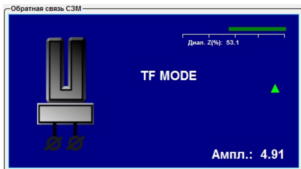
Рис. 4.34 Переключение в режим резонансной микроскопии при использовании кварцевых резонаторов.
