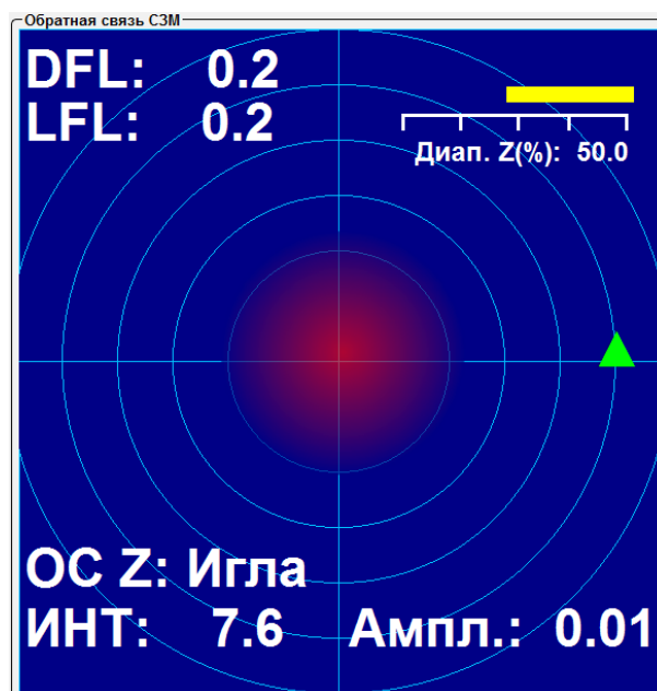
Рис. 4.26 Лазерное пятно в центре фотодиода.
